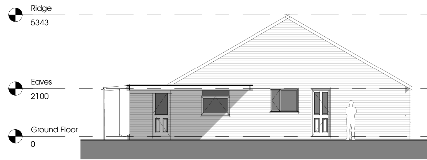
E3 Existing Side Elevation 1 : 100
