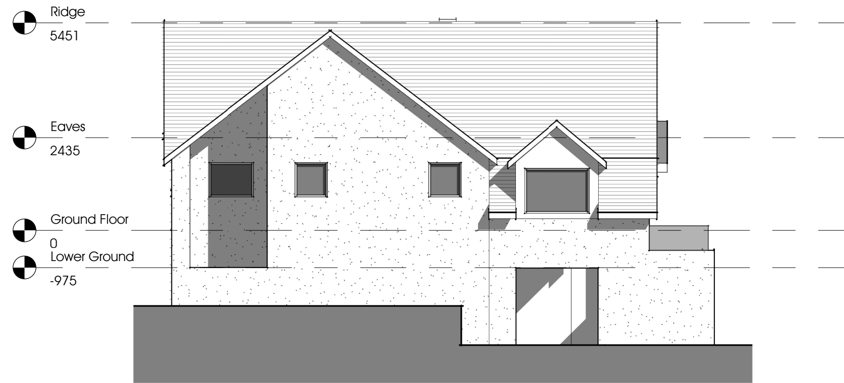
E2 Existing Side Elevation 1 : 100
